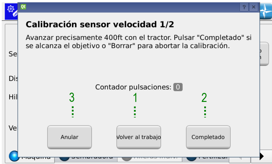
Figura 3-16 Calibración sensor de velocidad
