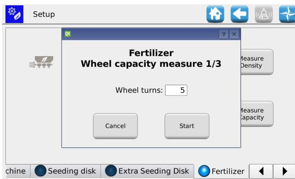
En définissant un numéro de tours désiré le système fera tourner le moteur connecté à l'épandeur d'engrais 1 ou au microgranulateur 1. Il mesure la quantité de débit et la fractionne par le numéro de tours ; au cas où celle-ci est différente de  $1\text{kg/dm}^3$ , même par la densité, c'est-à-dire :
