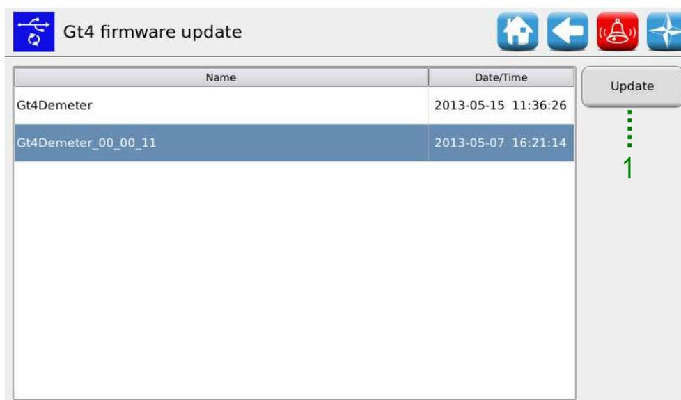
En sélectionnez le logiciel désiré dans la liste indiquée et en appuyant sur le bouton **1** il est possible de procéder à la mise à jour du logiciel de l'HMI. Lorsque la mise à jour est terminée la console s'éteint et le système est redémarré.
