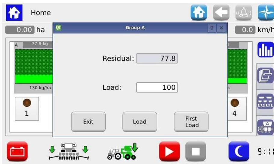
Premendo il tasto Load verrà aggiunta la quantità indicata al residuo, premendo First Load verrà resettato il campo residuo e caricata la quantità indicata.
