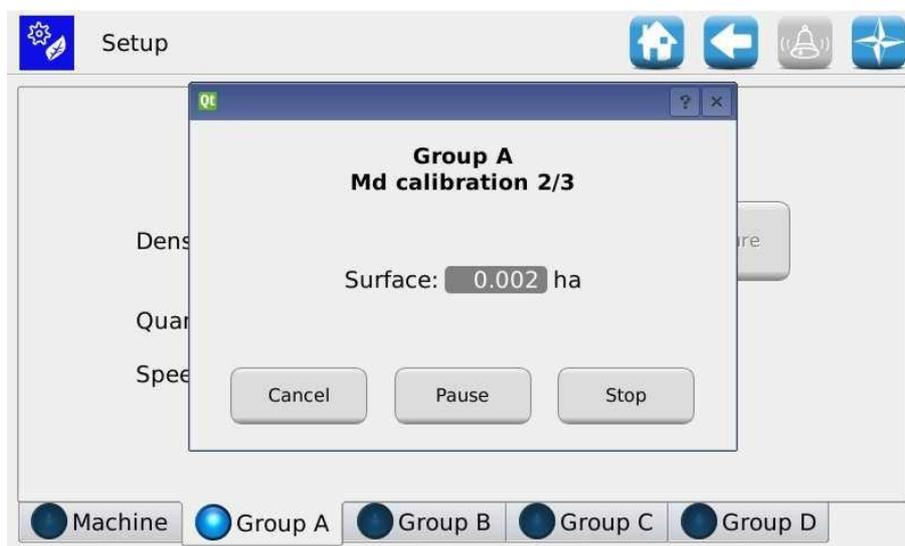
Premendo stop, come per la misura del volume della coclea descritta in precedenza, la schermata permette di inserire la quantità pesata e automaticamente calcolerà la densità del prodotto corretta.
